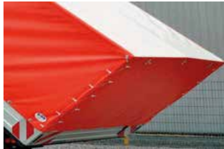
Plane/ Spriegel Aufbau Warmmarkierung rot/ weiß
