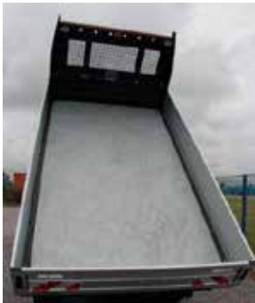
Holzboden mit Blechbelag (verzinkt)
