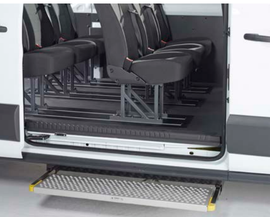
Die optionale elektrische Trittstufe von AMF-Brunns für die Seitenschleibetür ermöglicht einen leichten Einstieg in den Fahrgastraum.
