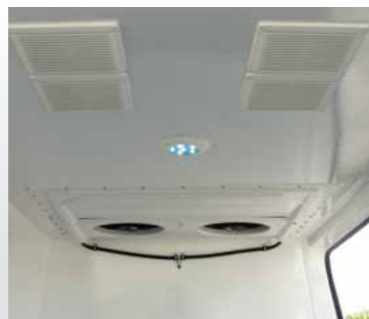
Sonderausstattung: Energiesparende LED-Innenleuchte mit Bewegungsmelder.
