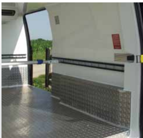
Sonderausstattung: Verschweißte Bodenwanne und Ladungssicherungssysteme.
