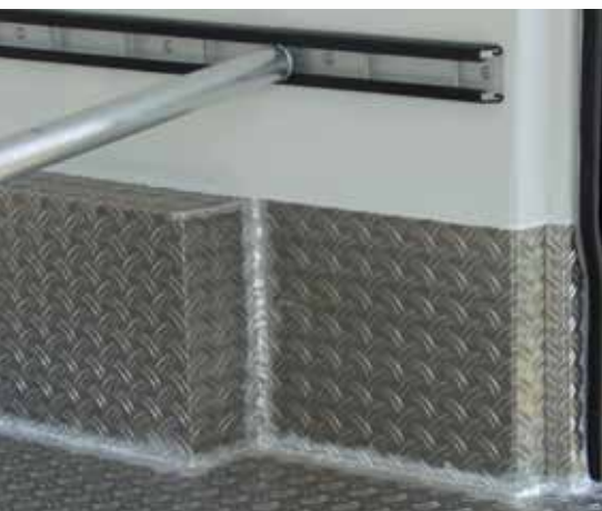
Sonderausstattung: Verschweißte Bodenwanne und Ladungssicherungssysteme.
